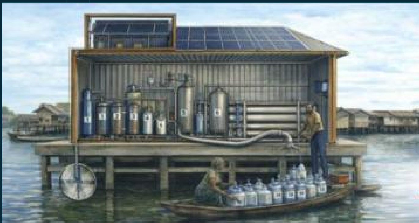
FIG.01 – MICRO-UNITÉ MUPEL FLOTTANTE SOLAIRE, ZONE LACUSTRE (BÉNIN)
